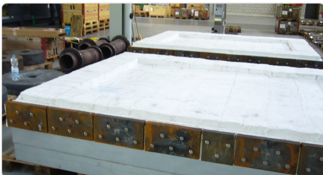
Tampas com revestimento concluído na oficina
