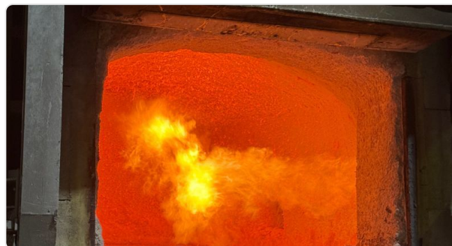
Superfície densa e com poucas juntas na zona da cuba
