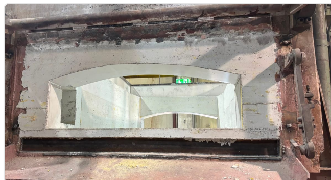
Frente do forno: abertura e porta adaptadas à nova geometria
