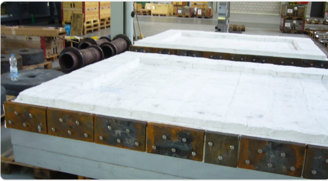
Fertig zugestellte Deckel in der Werkstatt
