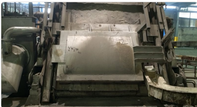
Ankerfeld vóór het aanbrengen van de massa
