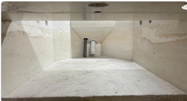
Doseeroven: krappe geometrie, permanent metaalcontact
