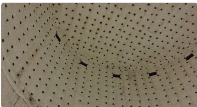
Biologisch oplosbare vezelisolatie voor de thermische barrière
