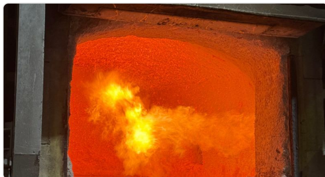
Dicht oppervlak met weinig voegen in het badgedeelte
