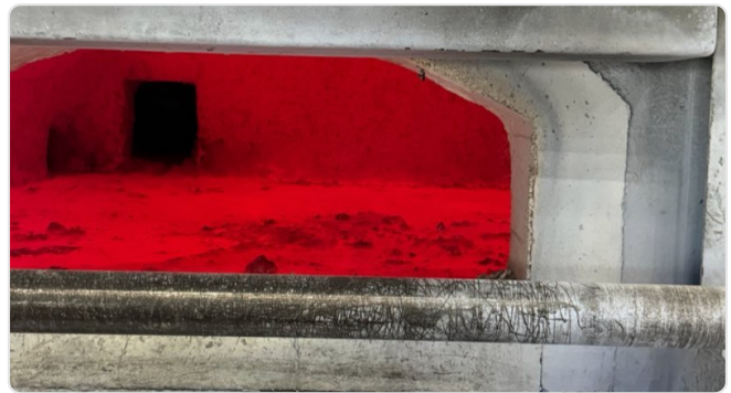
De badlijn: de zwaarst belaste band van de bekleding
