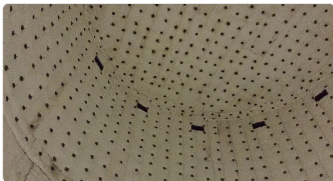
Isolamento in fibra biosolubile per la barriera termica
