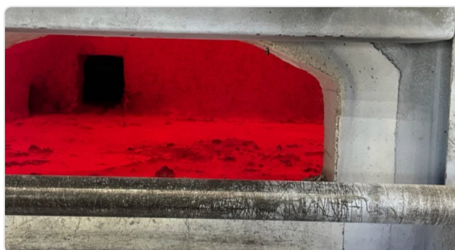
La linea del bagno: la fascia più sollecitata del rivestimento
