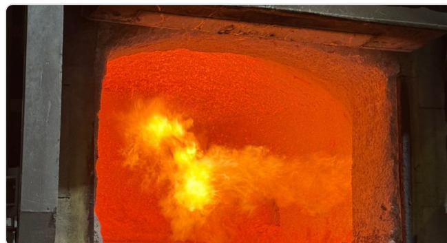
Surface dense, à joints réduits, dans la zone du bain
