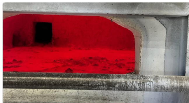
La ligne de bain : la bande la plus sollicitée du garnissage
