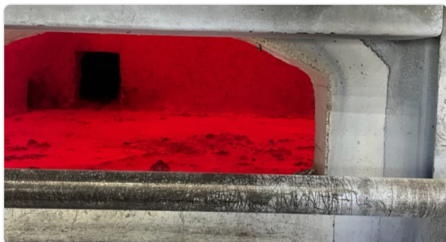
La franja sometida a carga en torno al nivel variable del metal
