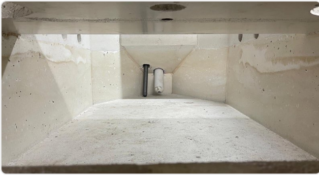
Dosierofen: enge Geometrie, ständiger Metallkontakt
