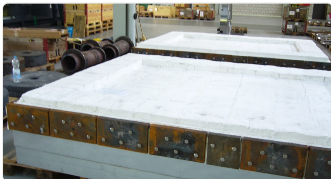
Hotově vyzděná víka v dílně
