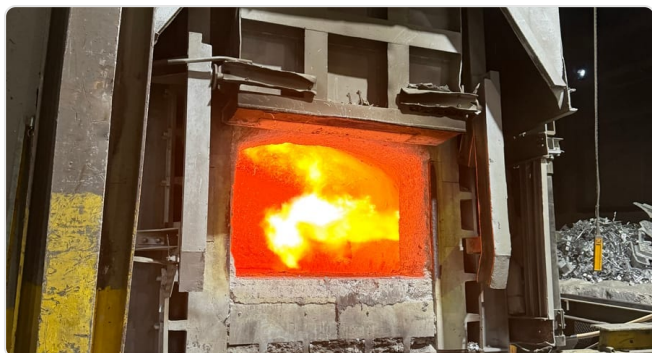
Plamen v pecním prostoru — rozhodující je, kam dopadá
