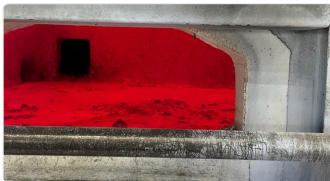
Hladinová čára: nejvíce zatížený pás vyzdívky
