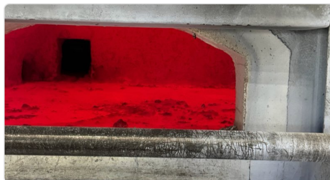
Die Badlinie: das am stärksten belastete Band der Zustellung
